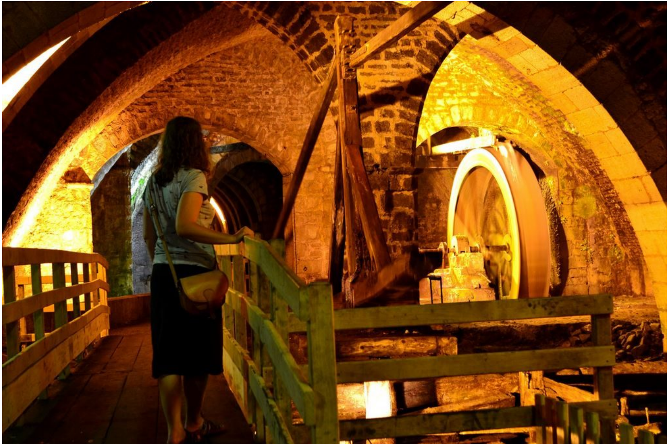
France. Grande saline de Salins-les-Bains. Des voûtes médiévales abritent une roue hydraulique et un balancier du XIXe siècle qui pompait une saumure chargée de 330 g de sel par litre d'eau. © Jura-Tourisme.
