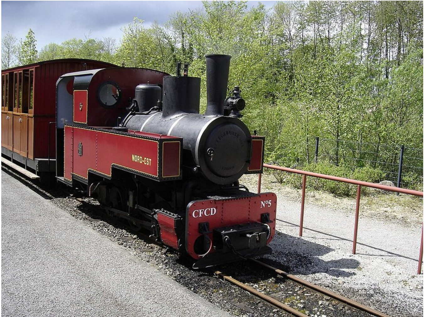
Locomotive construite par « Decauville » type 030 T (N°1652 de 1916) de l'APPEVA. Chemin de fer Froissy-Dompierre. © Hektor/Commons.
