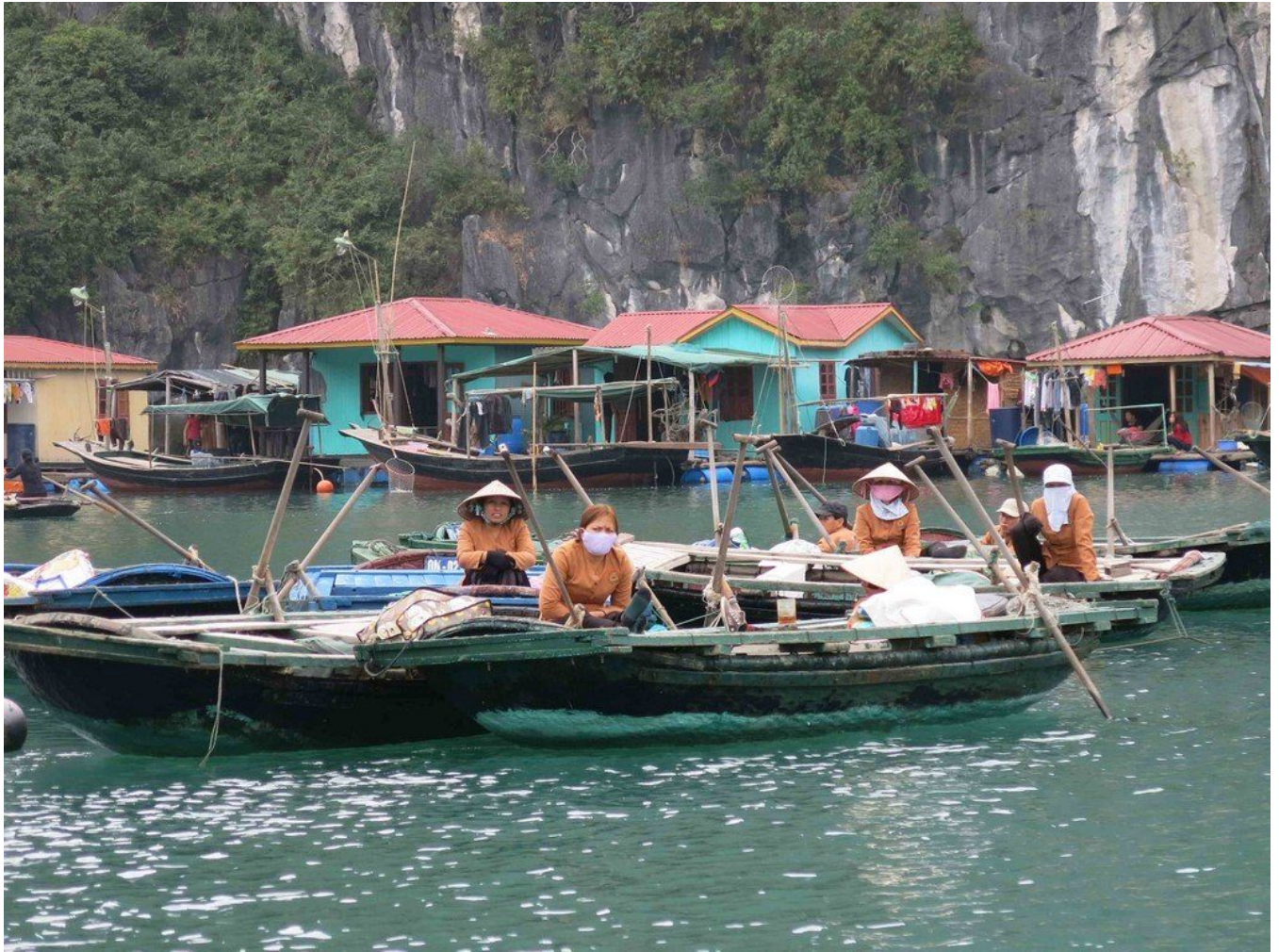
Vietnam. Les maisons sont construites sur des plateformes faites de barils vides et s'agglutinent formant ainsi des villages flottants.
